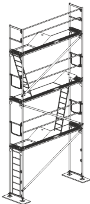
Rys 10. Pion komunikacyjny rusztowania DELTA 70
