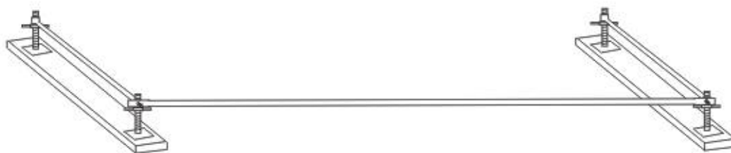
Rys 5. Montaż podstawek, belek stopowych i rygli podłużnych w polu bazowym
